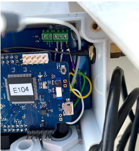
STS paineanturin kiinnitys noodikotelon sisällä
